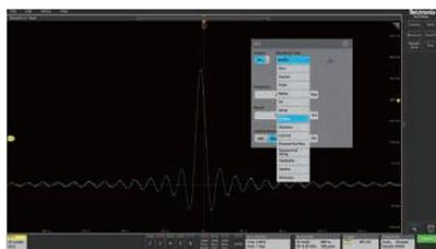
周波数50MHz(正弦波)、5Vpp出力の内蔵AFG機能の追加。正弦波、方形波、パルス波、ランプ波、三角波、DCレベル、ガウシアン、ローレンツなどのファンクション波形+任意波形。
