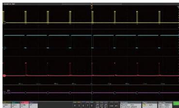
レコード長を62.5Mポイントに拡張することで、数千のシリアル・パケットでも1回で取込むことができ、高い分解能のままズーム表示して詳細に信号を観測し、信頼性の高い測定結果が記録可能。
