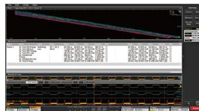
電力品質、入力容量、突入電流、高調波、スイッチング・ロス、安全動作領域(SOA)、変調、リップルなどの電源自動測定に加え、磁気測定、制御ループ応答(ボード線図)、電源電圧変動除去比(PSRR)の機能も提供。
