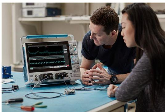
大型タッチ・ディスプレイ採用の次世代オシロスコープ。12ビットADCによる高垂直分解能や、FlexChannelによるデジタル・チャンネル拡張、Spectrum Viewによる画期的なスペクトラム解析機能など、革新技術を満載し、幅広い分野の設計、デバッグ、テストに最適。
