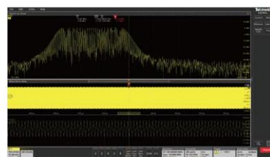
Spectrum Viewのオプション機能、RF対時間のハードウェア・トリガを追加。RF信号の挙動を簡単に分離、捕捉し、検査可能。RF振幅対時間やRF周波数対時間のエッジ、パルス幅、およびタイムアウトでもトリガ可能。
