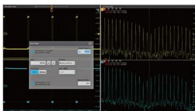
FFTと異なる画期的なスペクトラム解析機能、Spectrum Viewにより、効率的なスペクトラム解析が可能。時間ドメインと周波数ドメインの同時表示や、多チャンネル・スペクトラム解析も可能。取込み帯域拡張オプションで500MHzに拡張。
