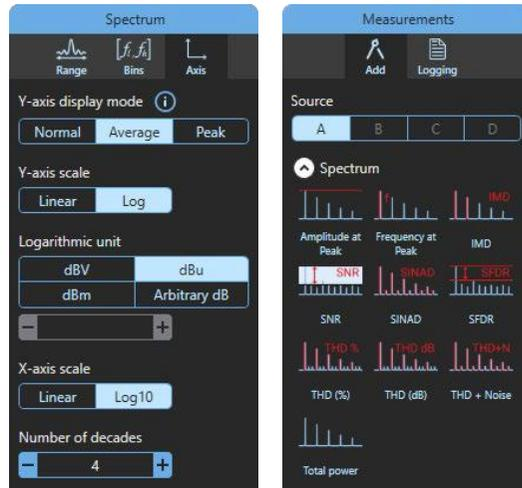
幅広い設定により、スペクトラムバンド (FFT ビン) の数、スケールリング (log/log を含む)、および表示モード (瞬時、平均、またはピークホールド) を選択できます。ウィンドウ関数の選択により、選択性、精度、ダイナミックレンジを最適化できます。
