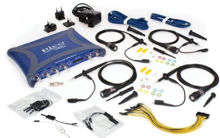
PicoScope 3418E MSO キット (P1053プローブ、MSOケーブル付)
