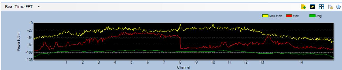
By ZigBee Channel を選択することにより、X 軸を ZigBee のチャンネルで表示することもできます。
