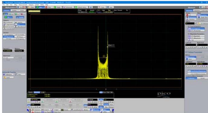
PicoScope 9400シリーズオシロスコープはすべて、様々な窓関数を使って入力信号の実数、虚数、複素数高速フーリエ変換および逆高速フーリエ変換を行うことができます。結果は数学関数を使ってさらに処理できます。FFTは、クロストークやひずみの検出、フィルター回路の調整、システムインパルス応答のテスト、ノイズおよび干渉ソースの特定・検出などに有益です。
