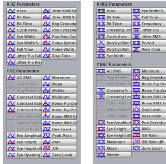
アイダイアグラム解析には、ビットレート、期間、交差時間、周波数、アイ幅、アイ振幅、平均、エリア、ジッター実効値 (RMS) などのデータが表示されます。グラフには、左・右実効値 (RMS) ジッターマーカーも表示されます。これらの測定結果は、アイダイアグラムのサイドメニューから選択可能で、グラフの下の画面上に一覧表示されます。
