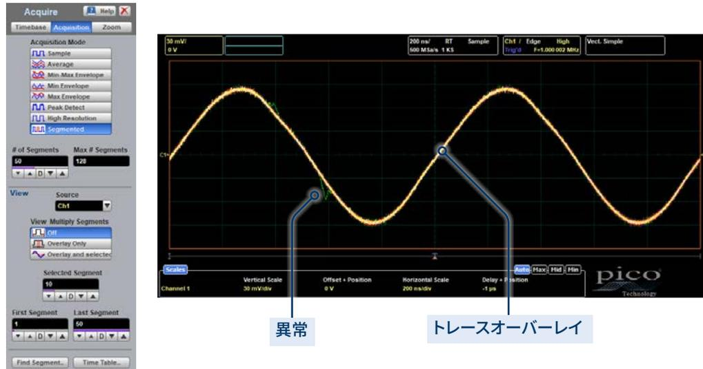
異常なイベントを捕捉し、スクロールして見たり、異常なトレースが検出されるまでオーバーレイトレースのより小さなブロック周辺のゲートを閉じたりできます。二分検索メソッドを使ってより多くのトレースセグメントを処理するセグメントファインダーもあります。
