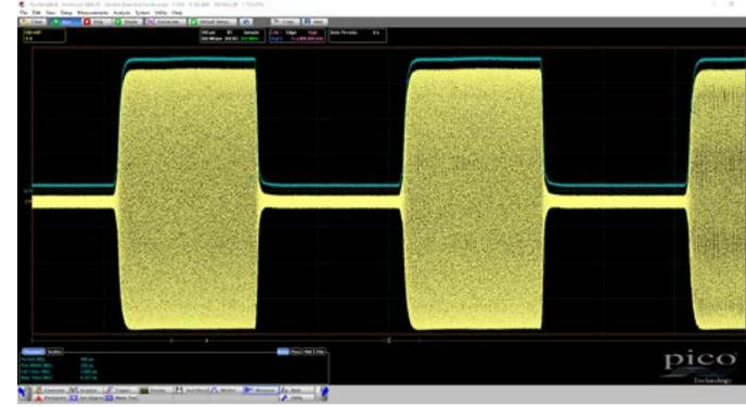
パルスRFキャリアは当社のモダンな通信インフラの中核にあります。最終的なキャリアパルス（たとえばアンテナの位置）の形状、収差、タイミングは測定が難しいこともあります。復調を選択すると、復調器の限度（帯域幅とひずみ）が適用される可能性があります。
