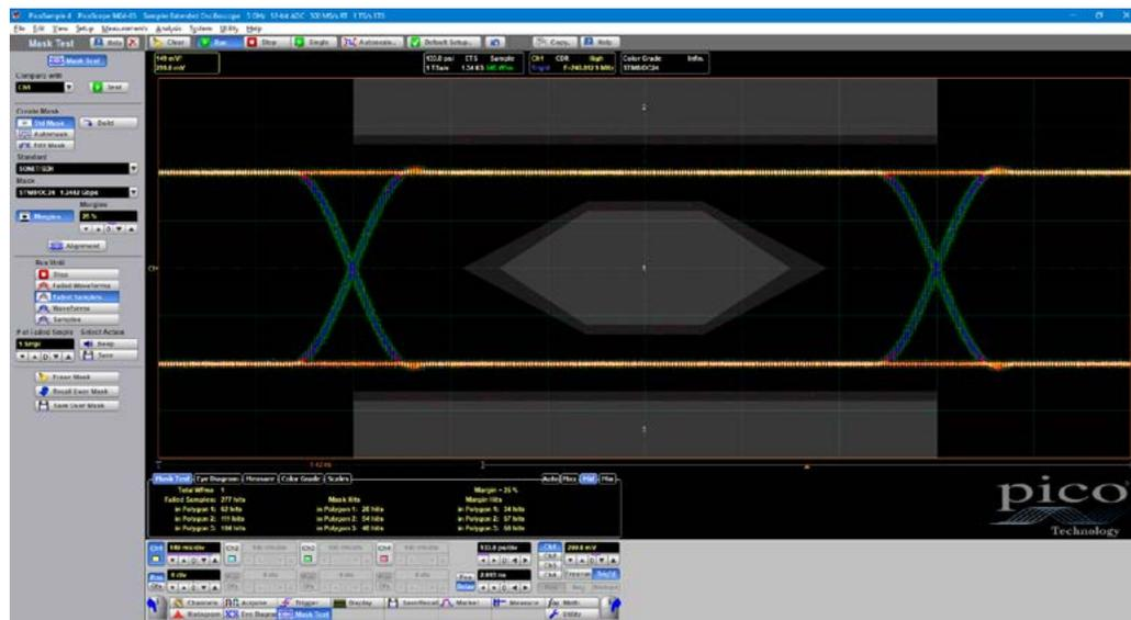
PicoSample 4には、データアイのテスト用のマスク130以上にバイナリが内蔵されています。マスクヒットをカウント・捕捉したり、それらヒットをアラームや取得コントロールにルートしたりできます。特定のマージンを使ってマスクに対してストレステストを実行することができます。ローカルでマスクをコンパイル・編集することも可能です。
