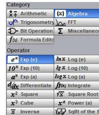
PicoScope 9400シリーズスコープは、取得した波形の同時演算コンビネーション、または関数変換に最大4つまで対応しています。
