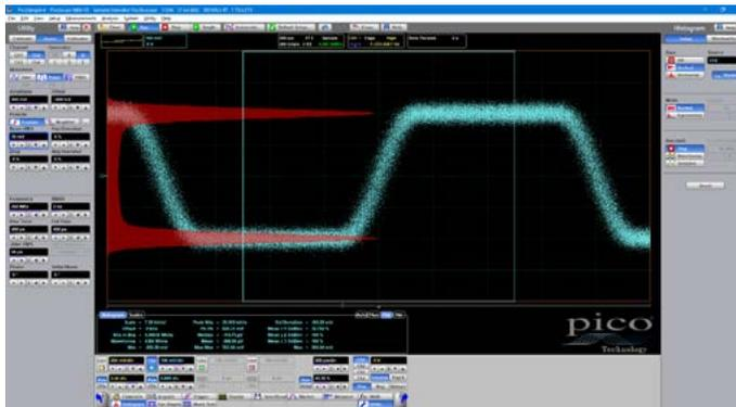
9400シリーズが強力な測定・表示能力を提供できるのは、高速かつ効率的なデータヒストグラム機能が搭載されているからです。装置の強力な可視化・解析ツールであるヒストグラムは、ユーザー定義ウィンドウ内のソースから取得したデータの分布を示す確率グラフです。
