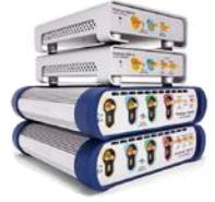
サンプルングオシロスコープとリアルタイムオシロスコープの機能を併せ持つSXRT0モデル。リアルタイムと等価サンプルングを併用でき、低周期の高周波信号の計測・解析に最適です。
