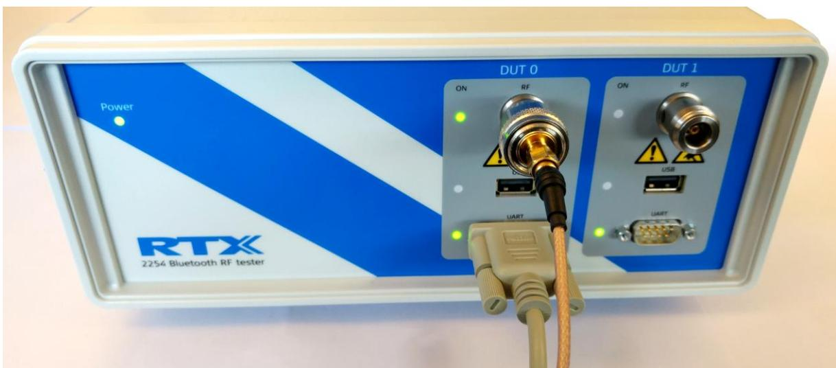
RTX2254 Bluetooth RF テスター・フロント・パネル – デュアル DUT (RTX no. 95101348)
