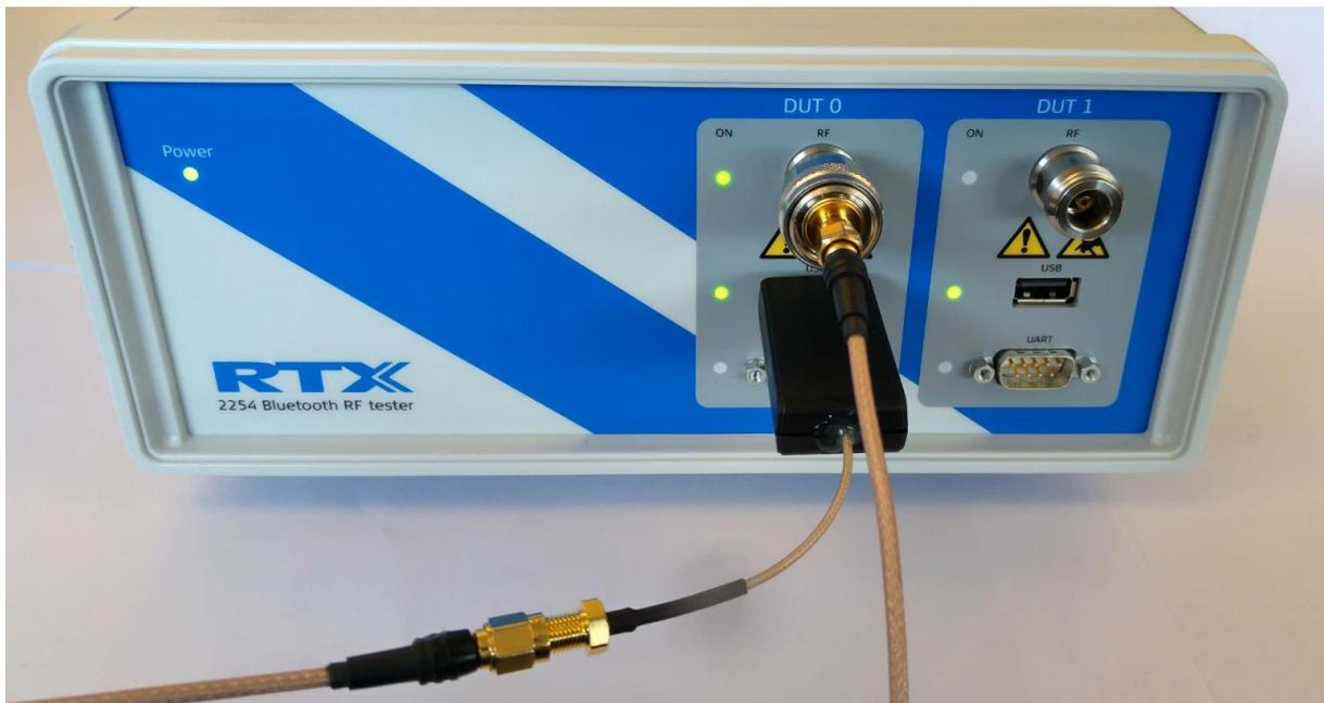
RTX2254 が USB で DUT と接続された例
