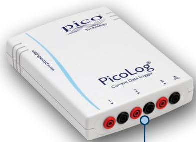
最大3つの電流クランプを接続可能な4mmソケット
