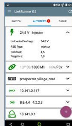
24V PoEインジェクタで使用する電圧とケーブルペアを確認
